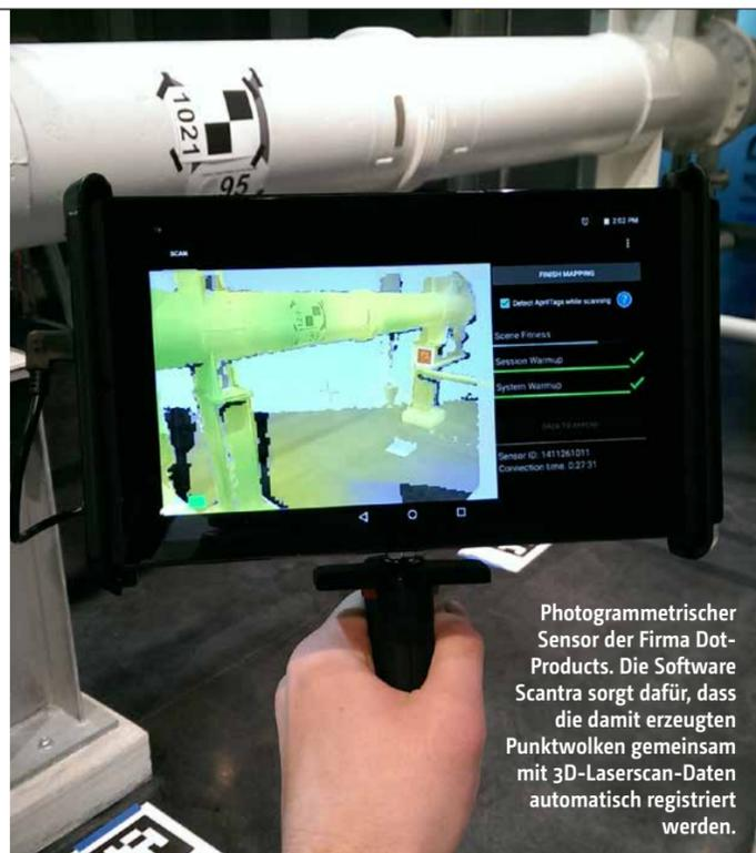
Photogrammetrischer Sensor der Firma Dot-Products. Die Software Scantra sorgt dafür, dass die damit erzeugten Punktwolken gemeinsam mit 3D-Laserscan-Daten automatisch registriert werden.
